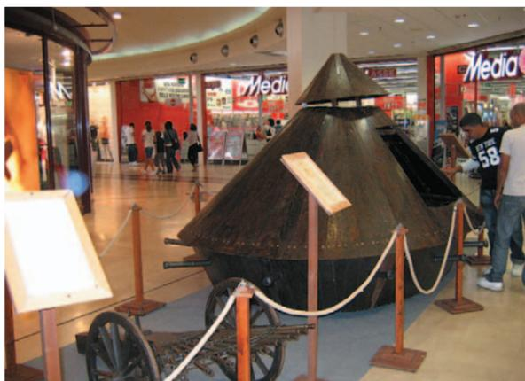
**CARRO ARMATO.** Carro a base circolare coperto da una corazza conica, con bocche da fuoco perimetrali. All'interno ruote dentate e a candela, mosse manualmente, spostano il carro in ogni direzione.
