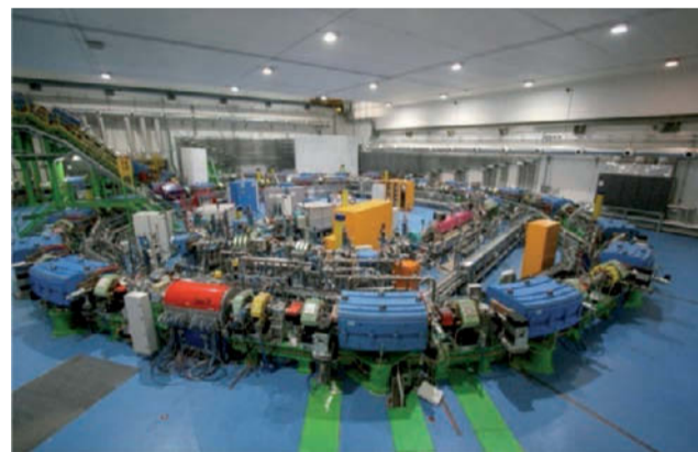
Vista d'insieme del sincrotrone del Centro Nazionale di Adroterapia Oncologica di Pavia. In primo piano il cilindro di colore rosso è la cavità acceleratrice a radiofrequenza; in blu sono visibili i magneti curvanti che trattengono le particelle nell'orbita circolare del raggio di 21 metri.
