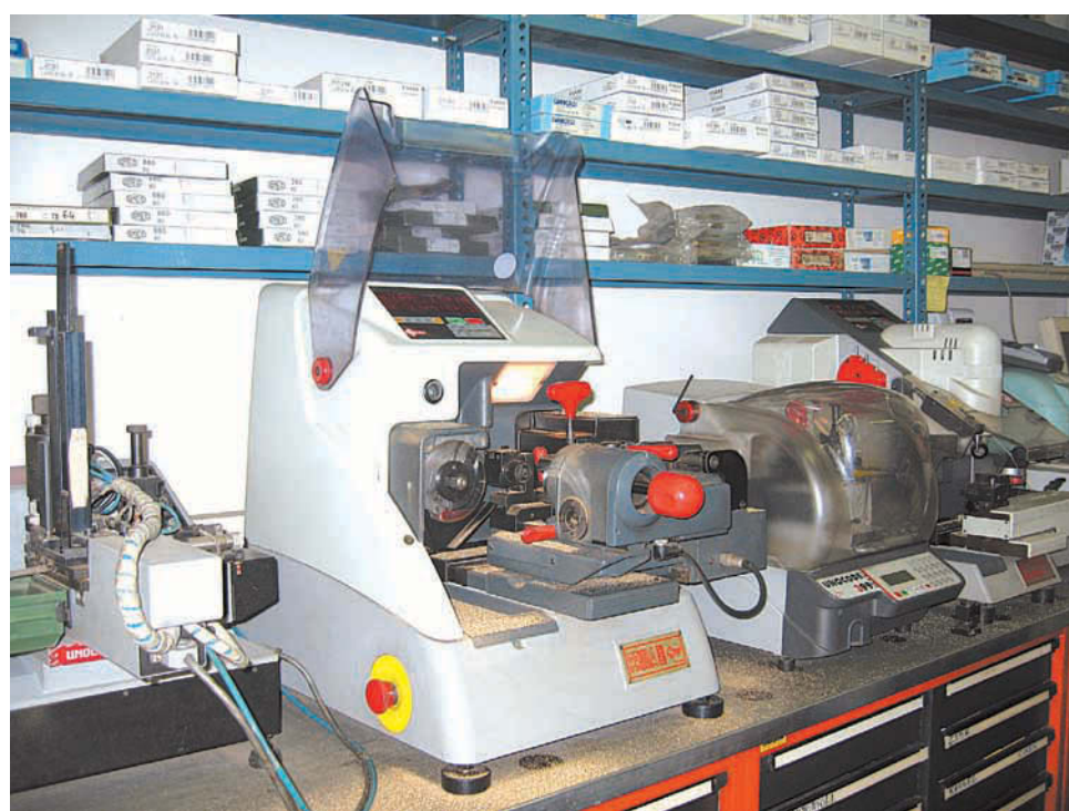
Differenti tipi di macchine per duplicare le chiavi, da Resmini
