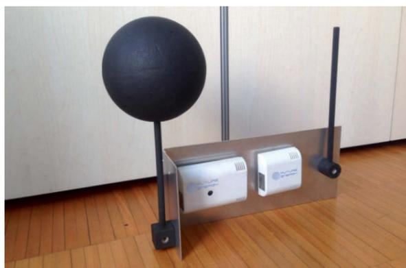
Il prototipo di sistema sensoristico per la valutazione dei parametri di benessere indoor
