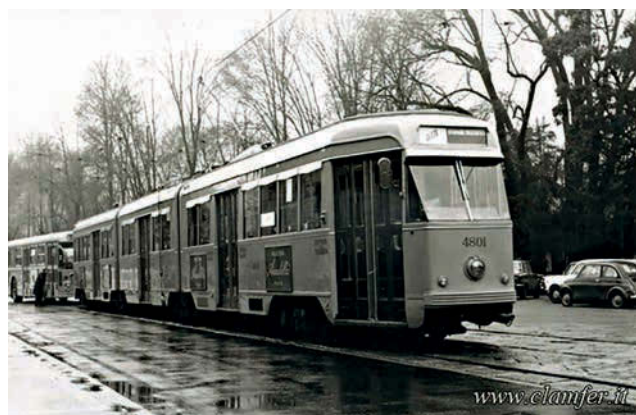
Qui la 4801, il prototipo, in prova prima del montaggio del pantografo sul tetto
